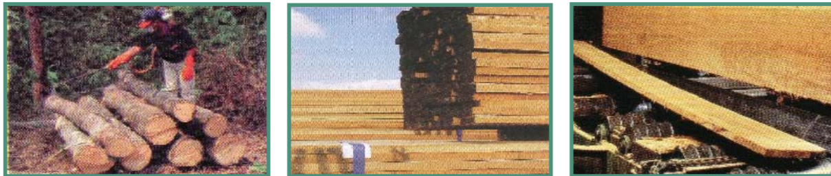
Gambar 6. Bentuk kayu: A. Kayu Dolken (Glondongan), B. Kayu Balok, C. Kayu Papan
